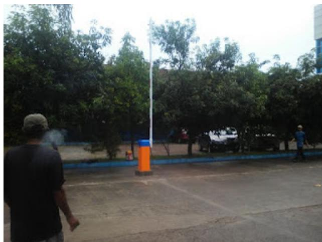
**Palang parkir atau barrier gate** panjang 4 meter terpasang 2 unit Tanpa menggunakan komputer atau pun sistem Parkir hanya menggunakan tombol push button yg di buka tutup oleh operator
