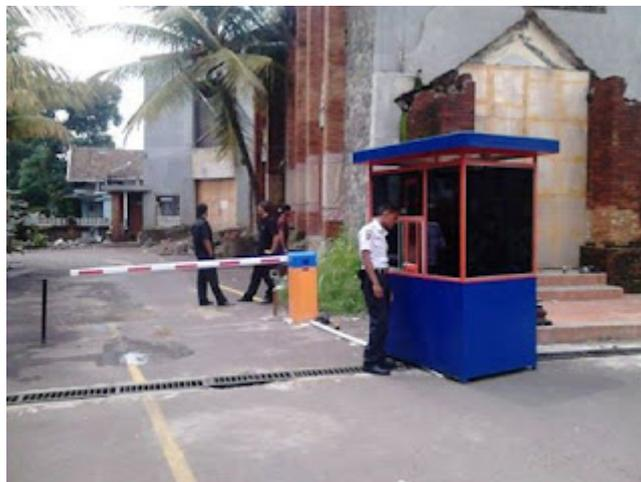
Pada pintu keluar terdapat satu Unit **Pos Parkir yang berisikan Komputer kasir yang terdiri atas Scanner barcode, Unit PC, Printer register serta RFID reader , Barrier gate, loop detector dan Camera**
